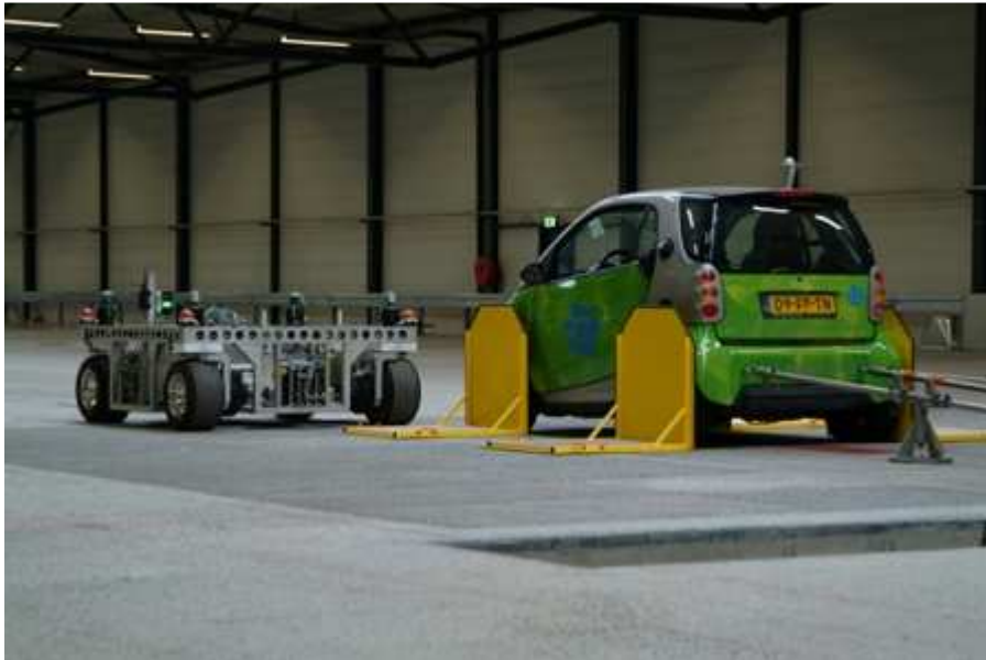
Figuur 3: VEHIL: Hardware-in-the-loop voertuig testfaciliteit in Helmond [Driessen et al., 2007]
